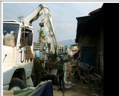
Figura 3 – Caminhão-guindaste com cabine parcialmente protegida por sacos de areia e por coletes balísticos pendurados nas portas
